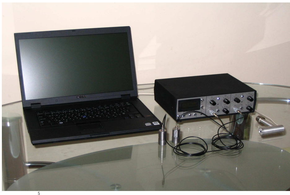
фиг. 4 Общ вид на системата за измерване и анализ на вибрационни и ударни процеси
